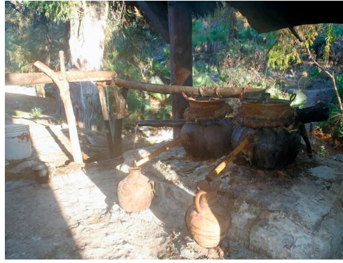
Figura 6. Canaletas sostenidas por horcones por donde corre el agua para enfriar la montera de los destiladores. Fotografía: Victor Hugo Romero Aranda, 2018.
